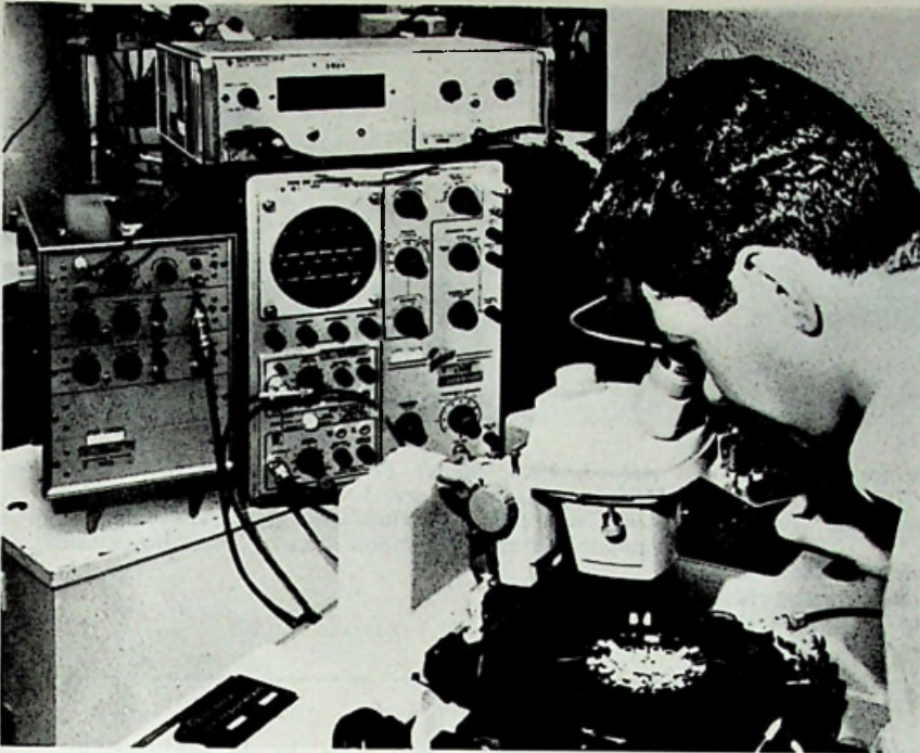
Afb. 1. Het testen van een multifunctie IC met een multipole probe. De test-apparatuur verricht automatisch de verschillende metingen aan de schakeling. Na het testen wordt het schijfje in ca. 250 plakjes versneden en in de behuizing aangebracht.
